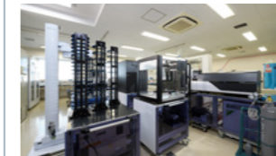
ロボットとデジタル技術、AIなどを活用したスマートセルインダストリー向け自律型実験システム(Autonomous Lab)
